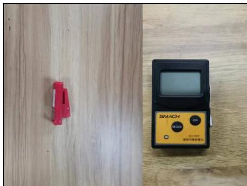
热释光个人剂量计及个人剂量报警仪
